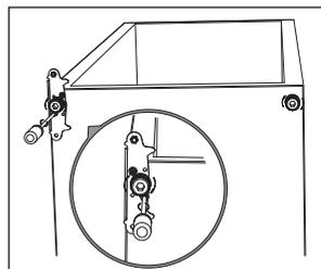
11. Vraťte dveře zpět. Než definitivně dotáhnete šrouby, zkontrolujte, zda dveře horizontálně i vertikálně líčují a zda těsnění po všech stranách správně dosedá.
