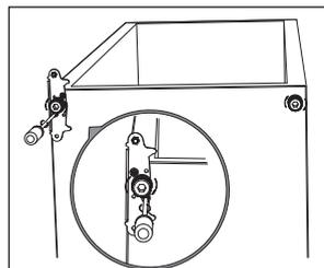
11. Vráťte dvere späť. Než definitívne dotiahnete skrutky, skontrolujte, či dvere horizontálne aj vertikálne doliehajú a či tesnenie po všetkých stranách správne dosadá.
