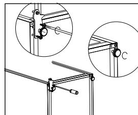
10. Postavte chladničku a nasadte dvere na spodný záves. Uistite sa, že čap spodného závesu je zasunutý do spodného otvoru dverí. Potom presuňte kryt otvoru dolných dverí z ľavej strany na pravú stranu.
