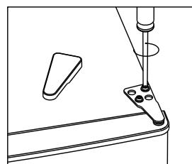
2. Odskrutkujte horný záves pomocou krížového skrutkovača.
