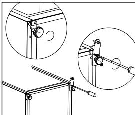
8. Odkręć i wyjmij dolny sworzeń zawiasu, odwróć wspornik i wymień go.
