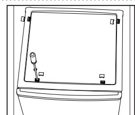
2. Odšroubujte horní závěs pomocí křížového šroubováku.
