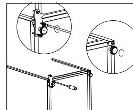
10. Odstawić urządzenie i założyć drzwi na dolny zawias. Upewnij się, że rdzeń zawiasu dolnego jest włożony do drzwi otwór. Następnie nasuń osłonę otworu na zawias w dolnych drzwiach z lewej na prawą.
