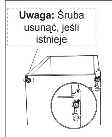
9. Odkręcić i wyjąć trzpień zawiasu dolnego, odwrócić kierunek wspornika i ponownie umieścić w nim trzpień.
